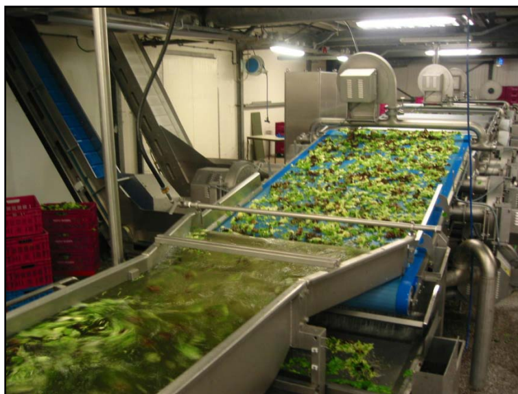
De nieuwe FTNON drooginstallatie met STIR® elementen is zowel geschikt voor salades en kruiden, als voor andere groentesoorten en champignons.
