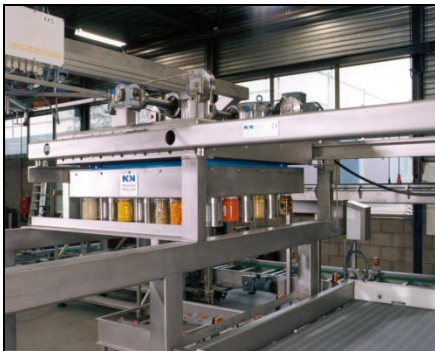
FTNON – Blik en glas Automatisch laad/los-systeem voor autoclaven door middel van een magnetische plaat
