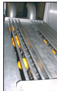
FTNON Perforatiesysteem t.b.v. de voorbereiding van het schillen van sinaas- appelen.
